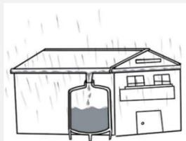
下雨時，雨水會沿著屋簷流入溝渠，最後接到雨水撲滿裡。
